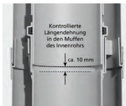
Vor dem Zusammenstecken auf richtigen Sitz aller Bauteile und insbesondere der Dichtungen achten. Steckverbindung mit Skoberne Gleitmittel einstreichen.
