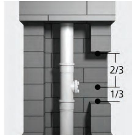
Revisionsöffnung im unteren Drittel der Schachtrevisionsöffnung positionieren (Dynamik)
