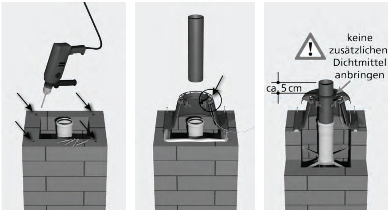
Schachtmündung vorbereiten für Montage der Schachtabdeckung. Vier Befestigungspunkte festlegen und Bohrungen für mitgelieferte Schlagdübel M6 vornehmen.
