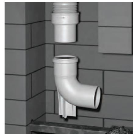
Gegenüber der Anschlussöffnung Bohrung anbringen (d=10-12mm).
