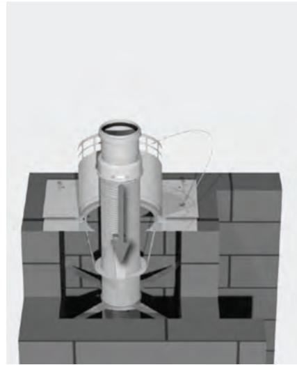
Flexrohr bedarfsgerecht kürzen und mit Kunststoffadapter flex/starr verbinden. Verbindungs-technik siehe Kapitel 4.2.3.
