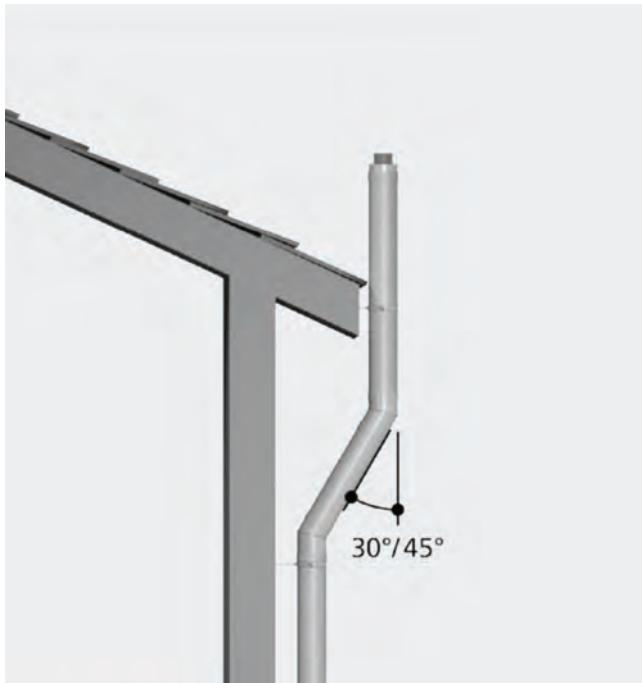
Bei bestimmten Situationen im Dachraum oder an der Außenwand kann es erforderlich sein, eine Schrägführung einzubauen. In Abstimmung mit dem/ der bevollmächtigten Bezirksschornsteinfegermeister/in sollte die Position eines eventuellen Revisionsstücks festgelegt werden.
