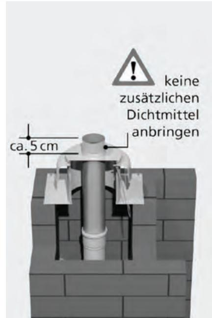
Schachtmündung vorbereiten für Montage der Schachtabdeckung. Vier Befestigungspunkte festlegen und Bohrungen für mitgelieferte Schlagdübel M6 vornehmen.
