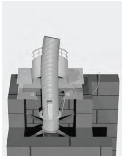
Mündungsübergang und Unterteil Schachtabdeckung auf den Schacht montieren mittels Schlagdübel.
