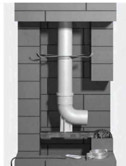
Die mögliche Montagehilfe (Seil, Rohrschelle...) von der Abgasleitung lösen und aus Schacht entfernen.
