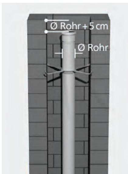
Das letzte Rohr soll aufgrund einer möglichen Metall-Mündungsausführung an bestimmter Stelle unter Schachtoberkante enden. Folgende Formel:
