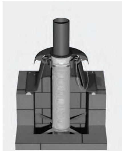
Halteseil in Ösenloch der Wetterhaube einfädeln. Wetterhaube über Mündungsrohr schieben und auf Unterteil fest einrasten.
