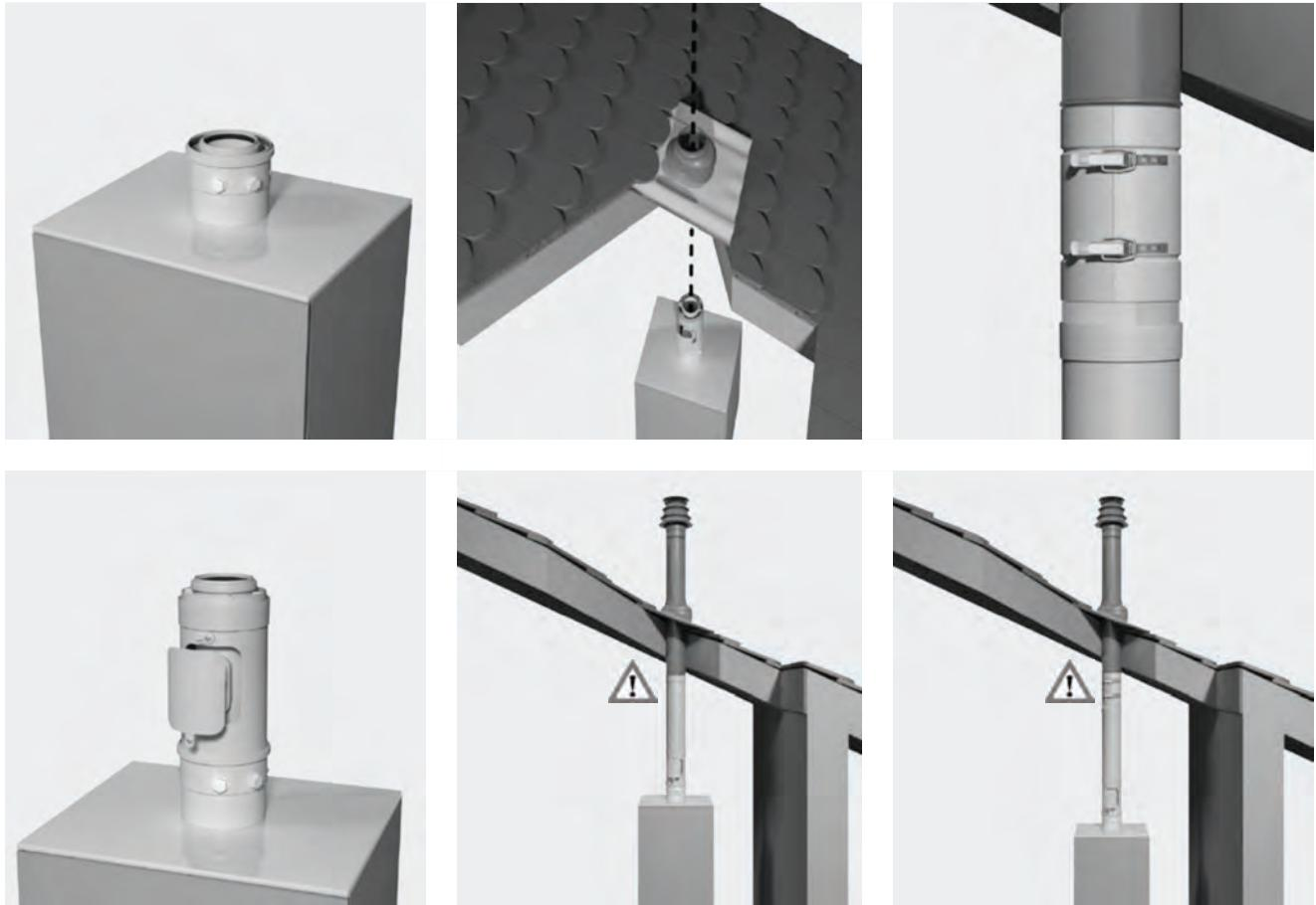
Anschlussstück am Kesselstutzen montieren. Messstück möglichst nahe am Wärmeerzeuger anbringen. Nötigenfalls Adapter zwischen Wärmeerzeuger und Messstück montieren. Revisionsöffnung in Abstimmung mit dem/der Schornsteinfegermeister/in bestimmen.
