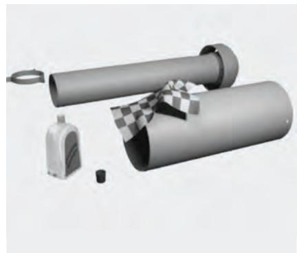
Konzentrische Rohre vor dem Kürzen demontieren. Schlitzschraubendreher unter Kunststoffmuffe in Höhe des Loches ansetzen und leicht anhebeln.
