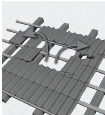
Pfannen entfernen und Unterkonstruktion vorbereiten für Universalschrägdachpfanne. Pfanne muss gegen Absinken unterbaut werden.
