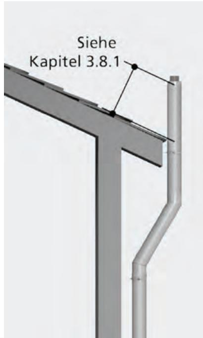
Bei bestimmten Situationen kann eine Schrägführung der konzentrischen Abgasleitung erforderlich sein. Hierzu werden 30° oder 45° Bögen verwendet. Mögliche Reinigungsöffnungen sind mit dem/der Bezirksschornsteinfegermeister/in abzustimmen.
