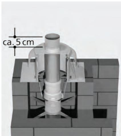
Metallisches Endrohr einführen und mit Kunststoffmuffe verbinden. Halteseil in Ösenloch der Wetterhaube einfädeln. Wetterhaube über Mündungsrohr schieben und auf Unterteil fest einrasten.
