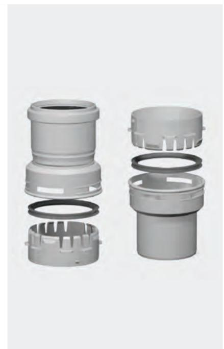
Vor dem Zusammenstecken mit einem Flex-Muffenformteil unbedingt die Dichtung mit Gleitmittel einstreichen. Danach das vormontierte Flexrohr inkl. Montagering einstecken. Sitz der 4 länglichen Rastnasen überprüfen. Öffnen der Verbindung jederzeit durch Drehbewegung möglich.
