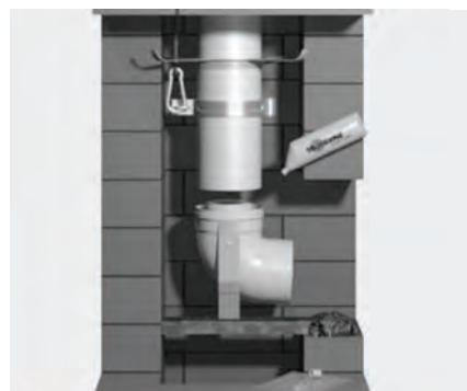
Rohre und Formstücke nach zuvor bestimmter Länge mittels Skoberne Gleitmittel zusammenstecken. Empfohlen wird eine bauseitige Montagehilfe, die auch ein Auseinanderziehen der Leitung verhindert. Beim Anbringen der Montagehilfe das Steckende zum Stützbogen beachten.
