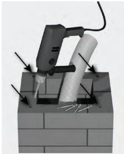
Schachtmündung vorbereiten für Montage der Schachtabdeckung. Vier Befestigungspunkte festlegen und Bohrungen für mitgelieferte Schlagdübel M6 vornehmen.
