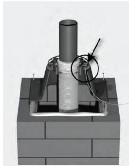
Das Unterteil der Schachtabdeckung montieren mittels mitgelieferter Schlagdübel. Geeignete Dichtmasse (witterungs- und UV-beständig) zwischen Schacht und Schachtabdeckung verwenden.
