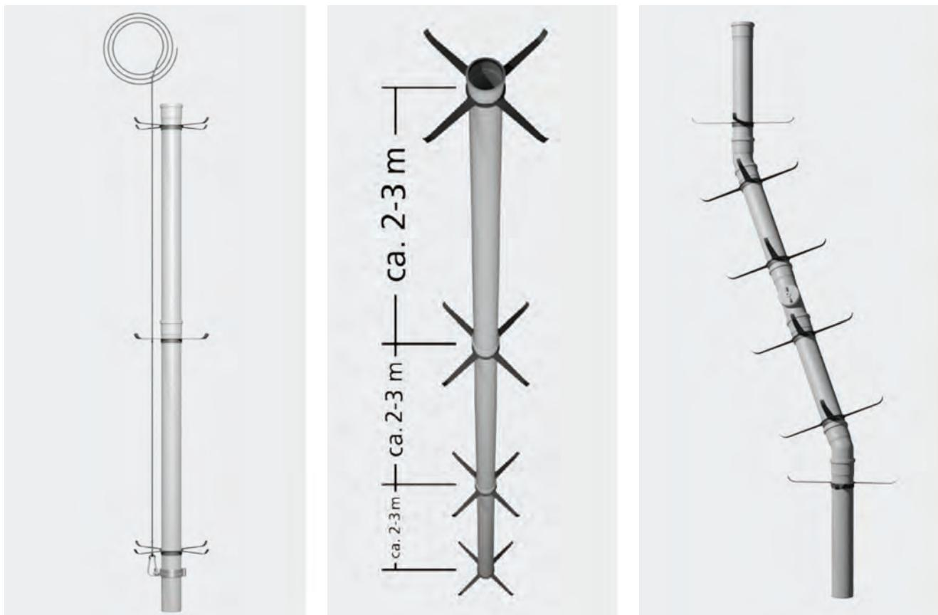
Rohre und Formstücke nach zuvor bestimmter Länge mittels Skoberne Gleitmittel zusammenstecken.
