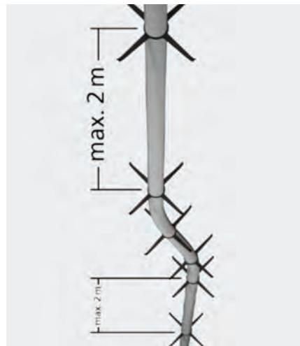
**⚠️** Das Flexrohr kann bis zu einer Länge von 30 m eingesetzt werden. Der Verzug ist bis auf Neigungen von 45° beschränkt. Größere Neigungen werden voraussichtlich zu Schäden des Flexrohres führen.
