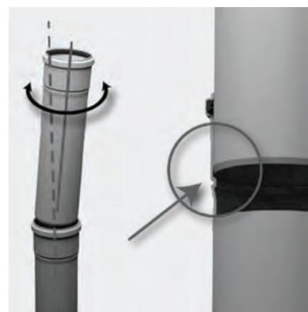
Bauteile winklig schneiden und insbesondere entgraten.
